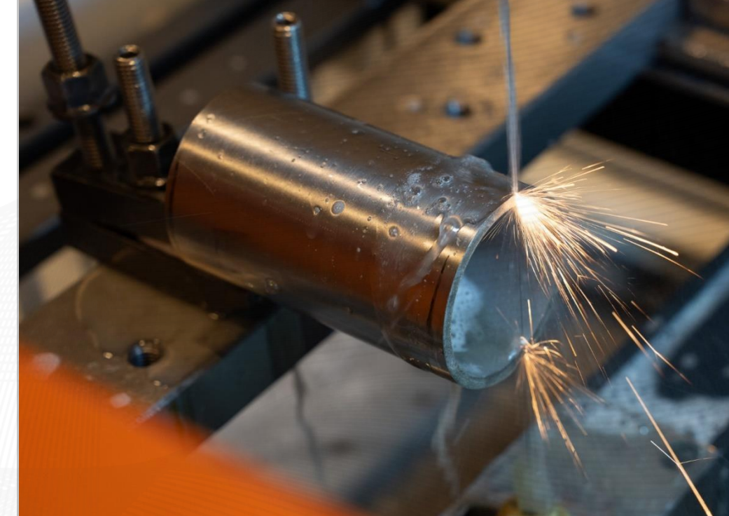
Przecinarka elektroiskrowa (cięcie prądem)
