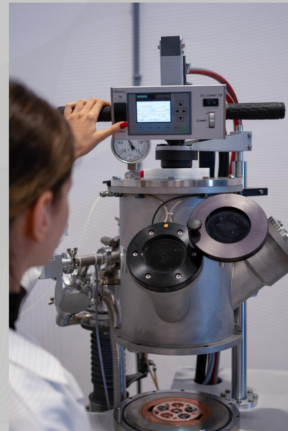
Piec łukowy, który podgrzewa wsad do 3000°C
