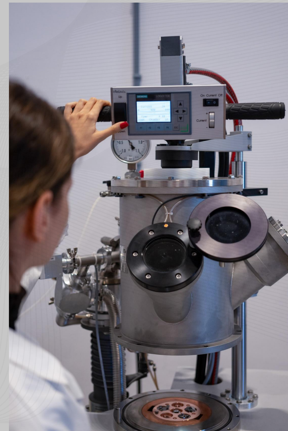
Piec łukowy, który podgrzewa wsad do 3000°C
